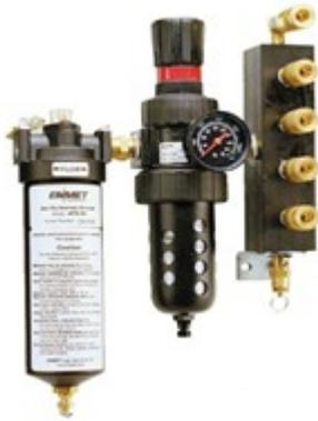
AFS-50 空气过滤系统是 ENMET 公司设计的用于给工人提供来自于呼吸空气压缩机高质量的呼吸空气设备，设备带有一个 CO 监控器，AFS-50 空气过滤系统由 2 级过滤油、水和固体颗粒的预过滤器/凝聚过滤器组成，附带一个用于消除来自于供气端的异味吸附器，凝聚过滤器是一种高效的除油雾和亚微粒过滤器。The AFS-50 的滤气容量为 50 CFM 并且带有 4 端口输出给使用者提供呼吸空气。AFS-50 适合与很多种 ENMET 公司制造的 CO 和 O<sub>2</sub> 监控器配套使用。AFS-50 空气过滤系统是十分紧凑设备而且适合安装在运送中的移动设备上或者配备在壁式安装盘上，可以带有或者不带有 CO/O<sub>2</sub> 监控器
